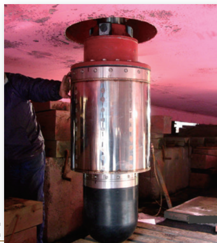
上：T-194型低周波送受波器 下：T-195型高周波送受波器
